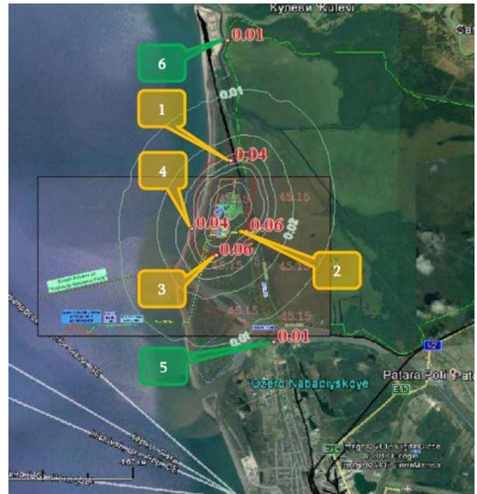
ნაჯერი ნახშირწყალბადების მძიმე ფრაქციის (კოდი 2754) მაქსიმალური კონცენტრაციები საკონტროლო წერტილებში (№ 1-4 ნორმირებულ 500 მ-იან ზონის საზღვარზე, № 5-6 –უახლოეს დასახლებასთან)
