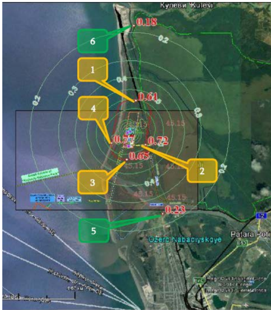
აზოტის დიოქსიდის (კოდი 301) მაქსიმალური კონცენტრაციები საკონტროლო წერტილებში (№ 1-4 ნორმირებულ 500 მ-იან ზონის საზღვარზე, № 5-6 -უახლოეს დასახლებასთან)
