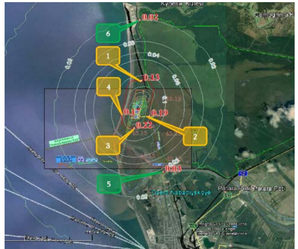
ნაჯერი ნახშირწყალბადების მძიმე ფრაქციის (კოდი 2754) მაქსიმალური კონცენტრაციები საკონტროლო წერტილებში (№ 1-4 ნორმირებულ 500 მ-იან ზონის საზღვარზე, № 5-6 -უახლოეს დასახლებასთან)
