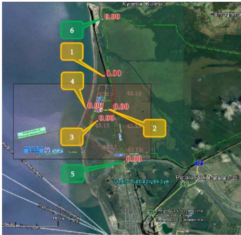
ნაჯერი ნახშირწყალბადების (კოდები 415, 416), ამილენების (კოდი 501), ბენზოლის (კოდი 602), ქსილოლის (კოდი 6016), ტოლუოლის (კოდი 621), ეთილბენზოლის (კოდი 627), ბენზინის (კოდი 2704) მაქსიმალური კონცენტრაციები საკონტროლო წერტილებში (№ 1-4 ნორმირებულ 500 მ-იან ზონის საზღვარზე, № 5-6 –უახლოეს დასახლებასთან)
