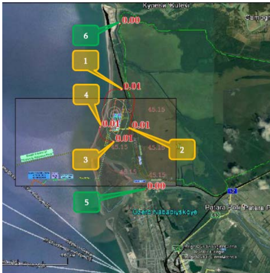
აზოტის ოქსიდის (კოდი 304) მაქსიმალური კონცენტრაციები საკონტროლო წერტილებში (№ 1-4 ნორმირებულ 500 მ-იან ზონის საზღვარზე, № 5-6 -უახლოეს დასახლებასთან)
