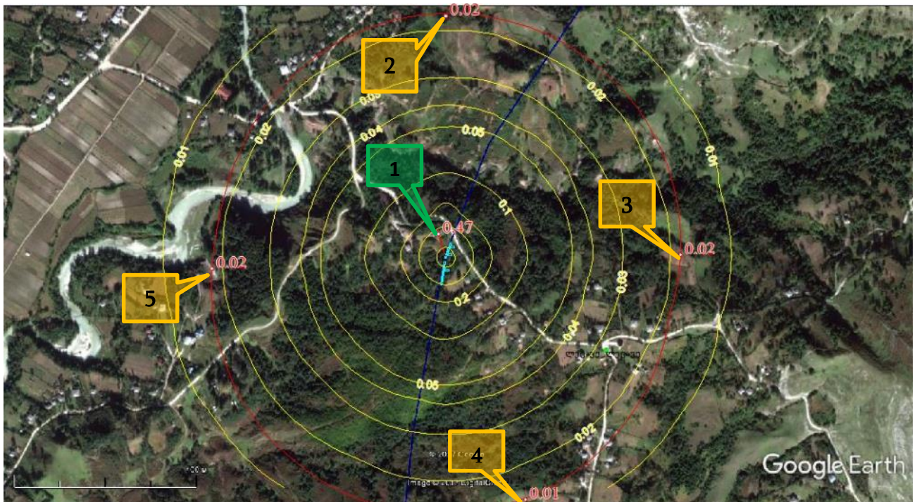
ნახ. 7.1.19 ვარიანტი 4 - ალტერნატიული კორიდორის ყველაზე სენსიტიური მონაკვეთი - შეწონილი ნაწილაკების (კოდი 2902) მაქსიმალური კონცენტრაციები დასახლებული ზონის საზღვარზე (წერტილი № 1) და 500 მ-იანი ზონის საზღვარზე (წერტილები № 2, 3, 4, 5.).
