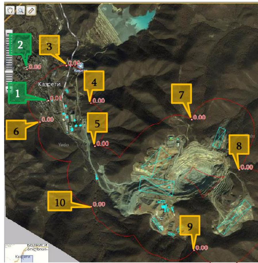
სუსტად ხსნადი ფტორიდების (კოდი 344) მაქსიმალური კონცენტრაციები საკონტროლო წერტილებში (№№ 1÷2 უახლოეს დასახლებასთან, №№ 3÷10 ნორმირებულ 500 მ-ნ ზონის საზღვარზე).
