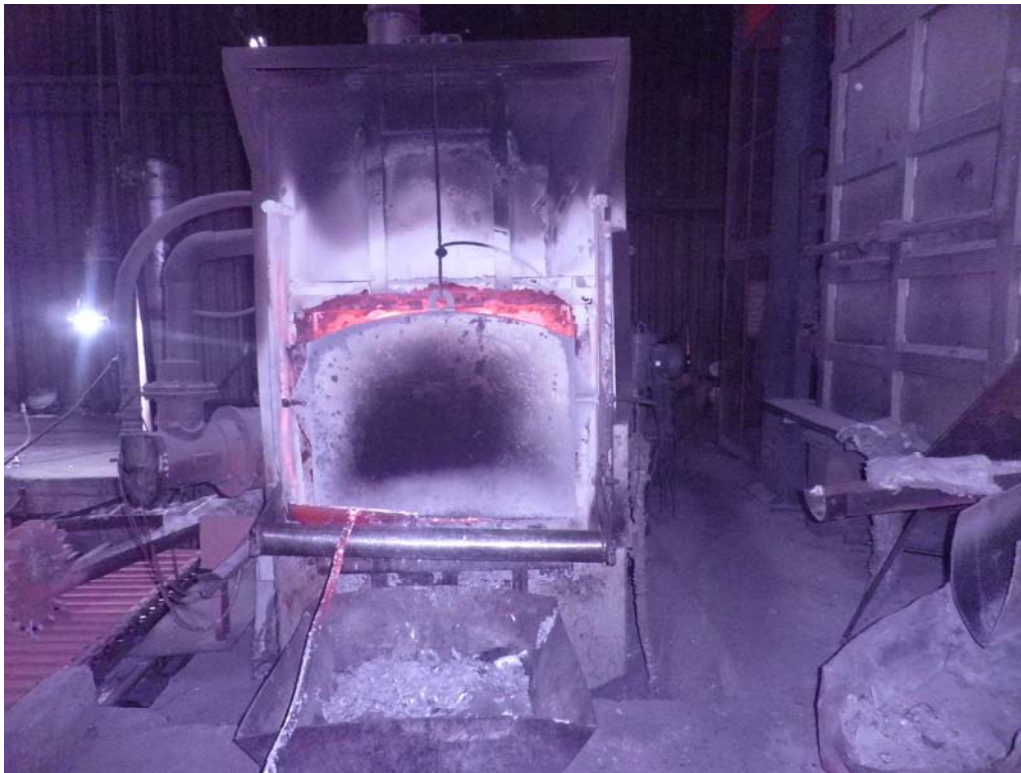
სურათი 4. შუალედური ჩამოსხმის ღუმელი.
