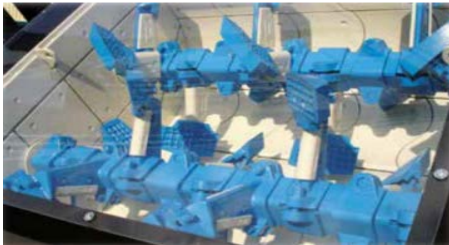
იხ. სურათი №9 ფალტშემრევი აგრეგატის ჭრილი
