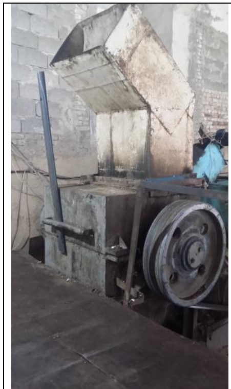
სურათი 4.2. პლასტმასის ნარჩენების როტორული დამჭეუცმაცებელი
