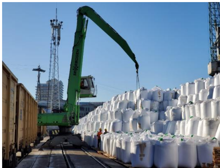
სურათი 2.3.1.2. „Zennebogen“-ის მარკის მობილური ამწეით ბიგ-ბეგების ჩამოტვირთვა ვაგონებიდან
