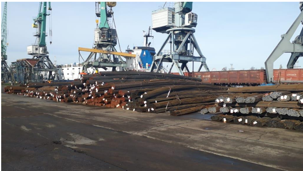
სურათი 2.3.2.1. ფოლადის არმატურის და ნაშადის ჩამოტვირთვის და დასაწყობების მეთოდები
