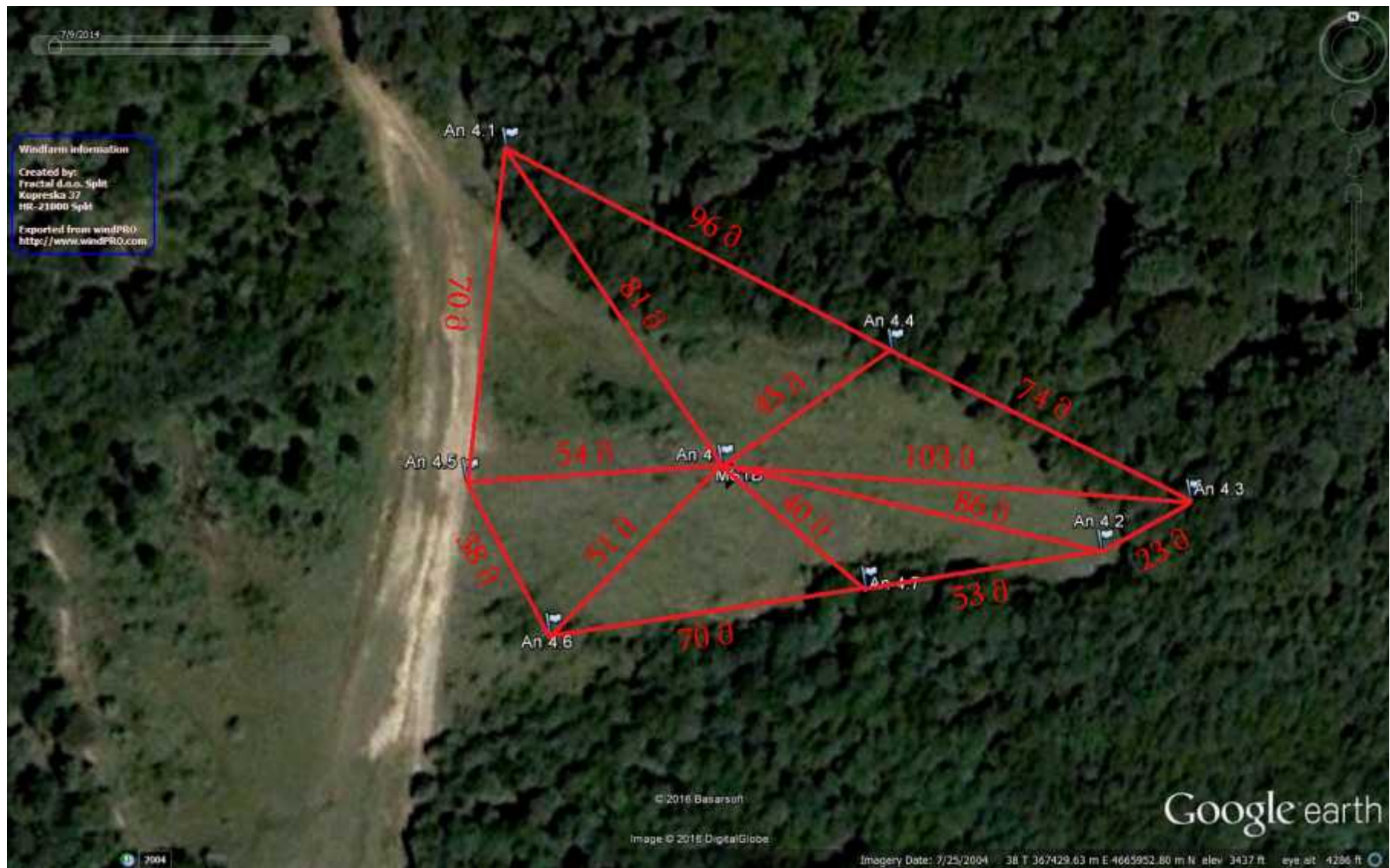
სურ. №12. ტერიტორია აეროფოტოზე, სადაც დაგეგმილია მეოთხე ანძის (An 4) განთავსება. მითითებულია რამოდენიმე წერტილი ანძიდან მინიმუმ 50 მეტრიანი დაშორებით
