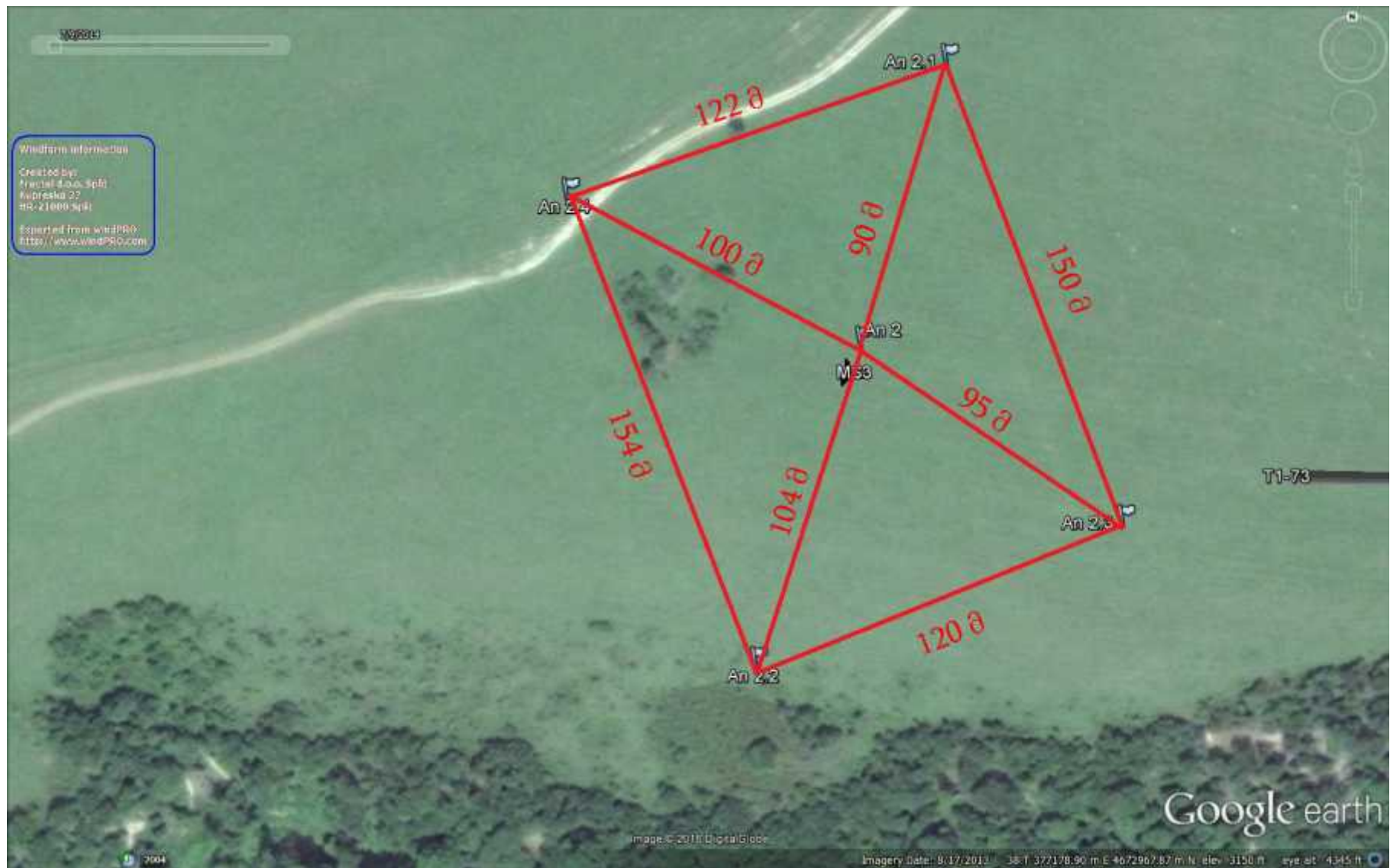
სურ. №8. ტერიტორია აეროფოტოზე, სადაც დაგეგმილია მეორე ანძის (An 2) განთავსება. მითითებულია რამოდენიმე წერტილი ანძიდან მინიმუმ 50 მეტრიანი დაშორებით
