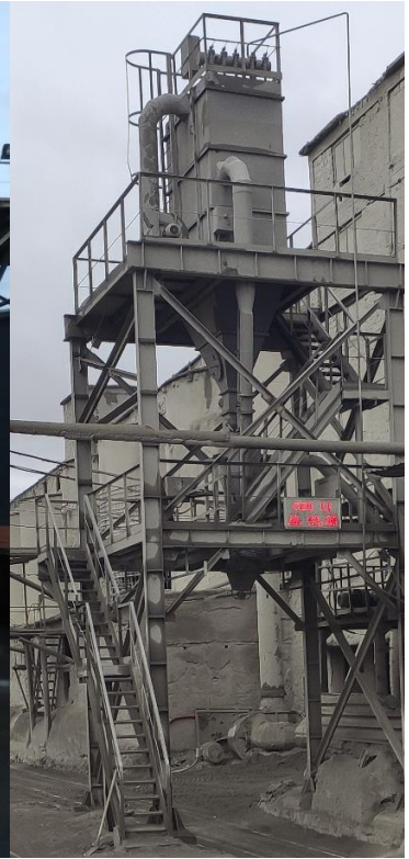
სურათი 2. ცემენტის რკინიგზის ვაგონებში დატვირთვის პუნქტი აღჭურვილია მტვერდამჭერი მოწყობილობით
