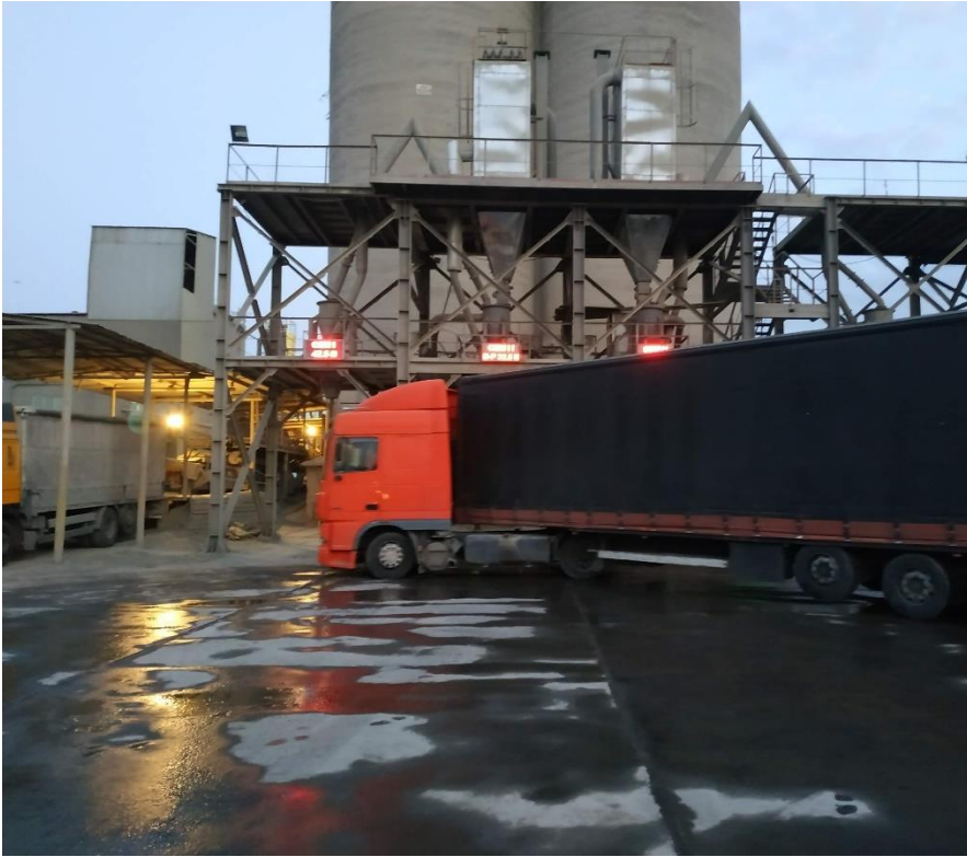
სურათი 1. ცემენტის ავტომობილებში დატვირთვის პუნქტი აღჭურვილია მტვერდამჭერი მოწყობილობით
