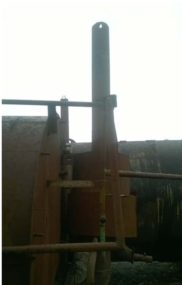
სურათი № 3.2.2. ბიტუმის გამაცხელებელი სანთურები გაფრქვევის მილით
