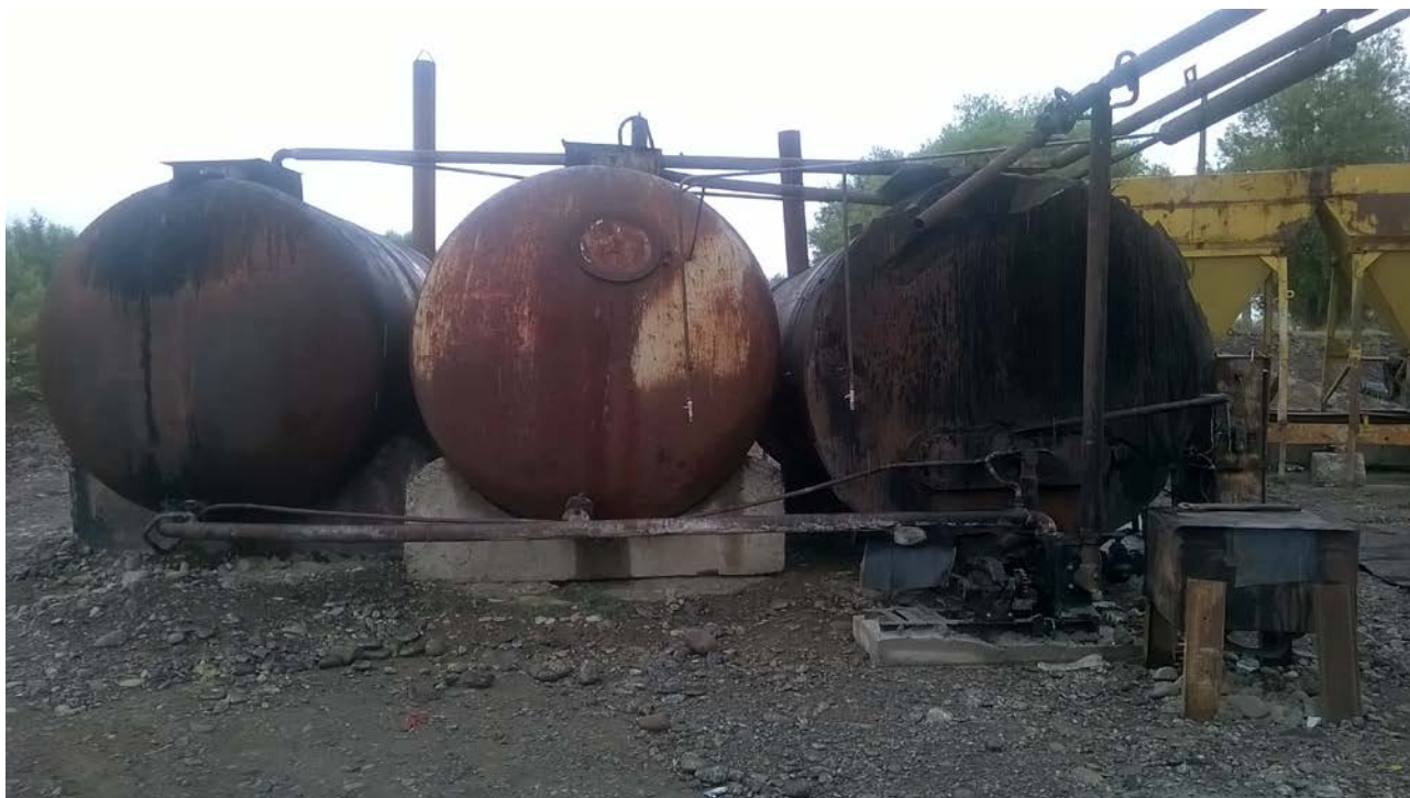
სურათი № 3.2.2. ბიტუმის გამაცხელებელი სანთურები გაფრქვევის მილით
