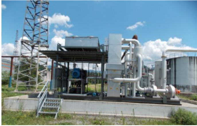
სურათი 3.16.2.5. ნავთობბაზის ნახშირწყალბადოვანი აირების სარეკუპერაციო დანადგარი
