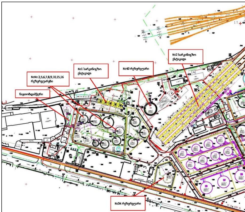
სურათი 3.3.1. დიზელის და ნავთის მიღების და გადატვირთვის სადგურის (დიზელის უბნის) რეზერვუარების სიტუაციური გეგმა
