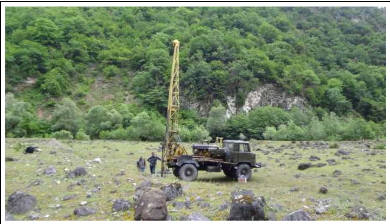
№ 23 ჭაბურღილის ბურღვის პროცესი საპროექტო ჰესის ცენტრალურ ნაწილში. უკანა პლანზე მოჩანს მდ. ჯონოულის ხეობის მარცხენა ქვედა ნაწილი, ცარცული (K) ასაკის კირქვების გამოსავლებით
