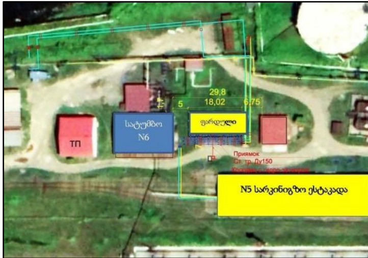
სურათი 16.12.1. სატუმბო სადგურის ფარდულის განთავსების სქემა
