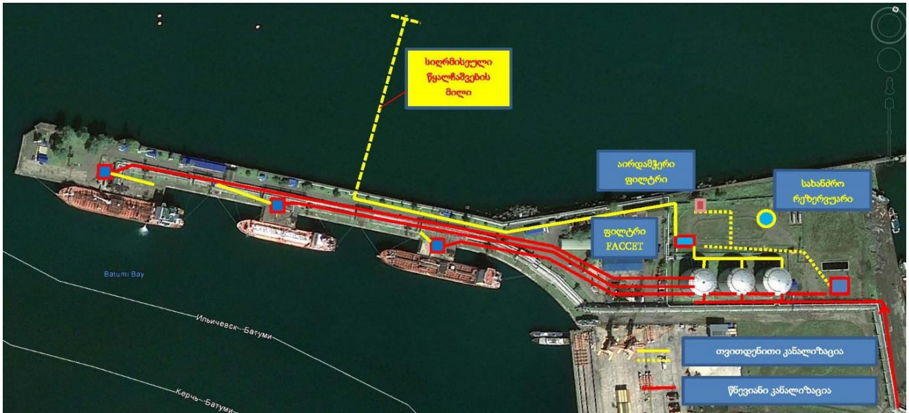
სურათი 7.1.5.1. ნავმისადგომების უბნის საწარმო-სანიაღვრო კანალიზაციის სისტემის გეგმა
