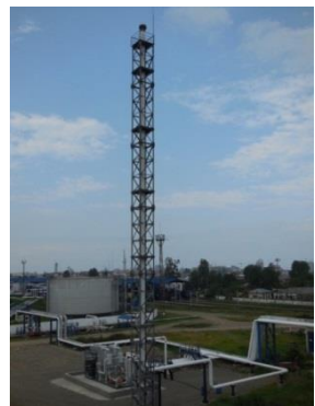
სურათი 13.5.9. აირგამწმენდი (აირების რეკუპერაციის) დანადგარი ნავთის უბანში
