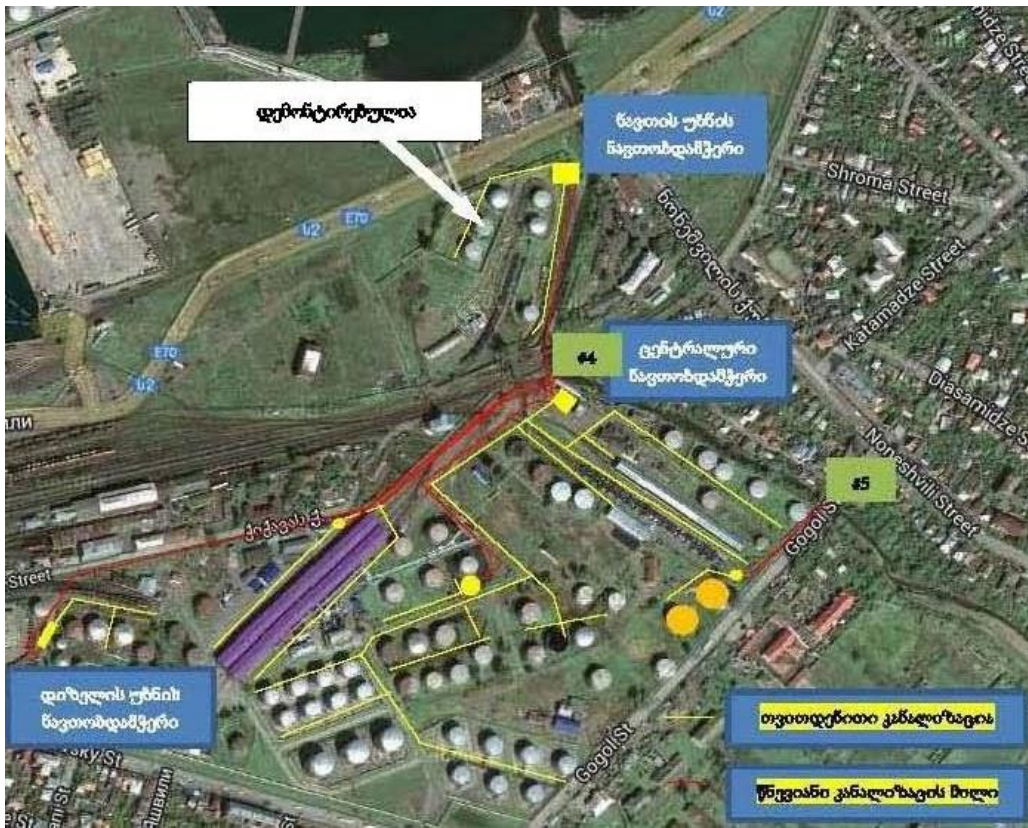
სურათი 7.1.4.1. ძირითად ტერიტორიაზე მუქი ნავთობპროდუქტების საწარმო-სანიაღვრო კანალიზაციის გეგმა
