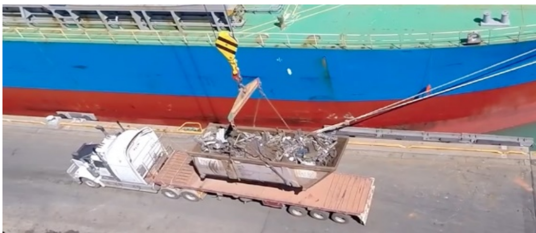
სურათი 15: ფოლადის ბუნკერები ჯართის მისაწოდებლად ნავმისაბმელზე
