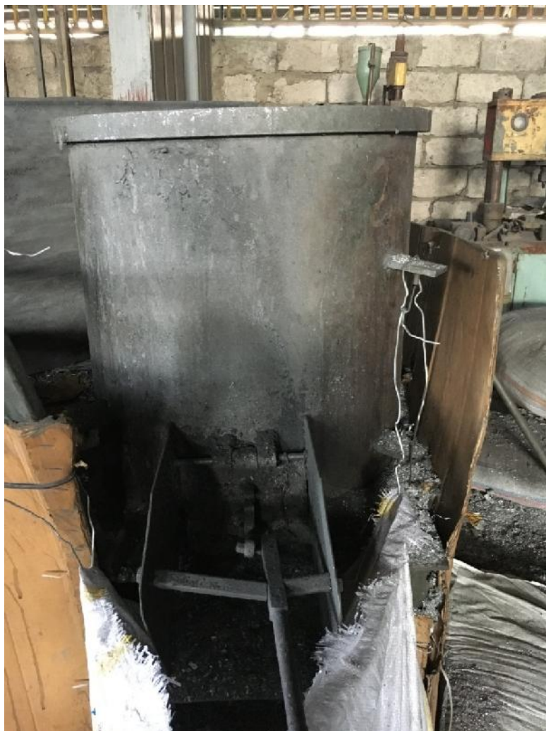
სურათი 4.3.1.7.1. ალუმინის ქილის დასაფქვავი დანადგარი (თვითნაკეთი)
