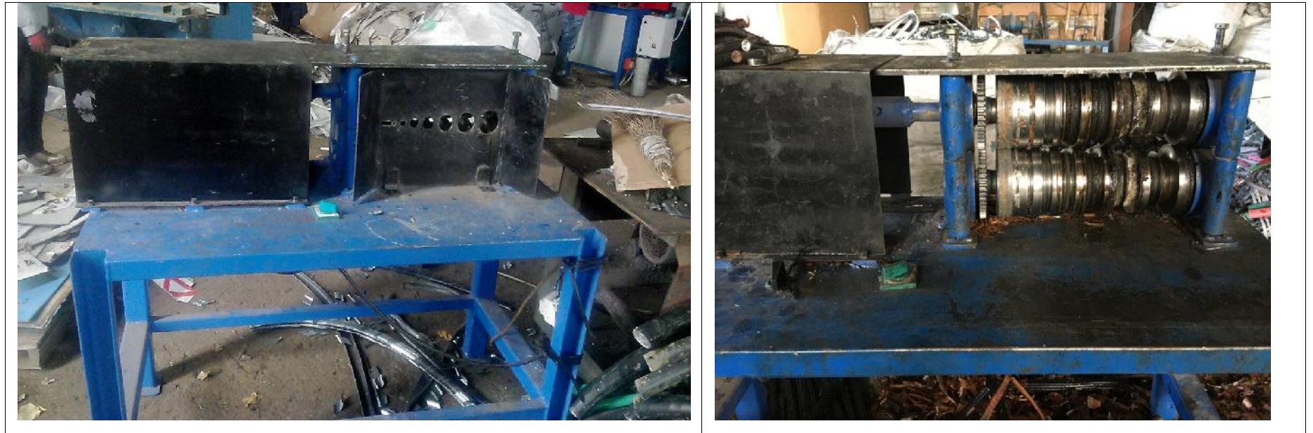
სურათი 4.3.1.3.3. ტექნოლოგიურ პროცესებში გამოყენებული ელექტროკაბელის გასაფცქვნიელი დანადგარი (თვითნაკეთი)
