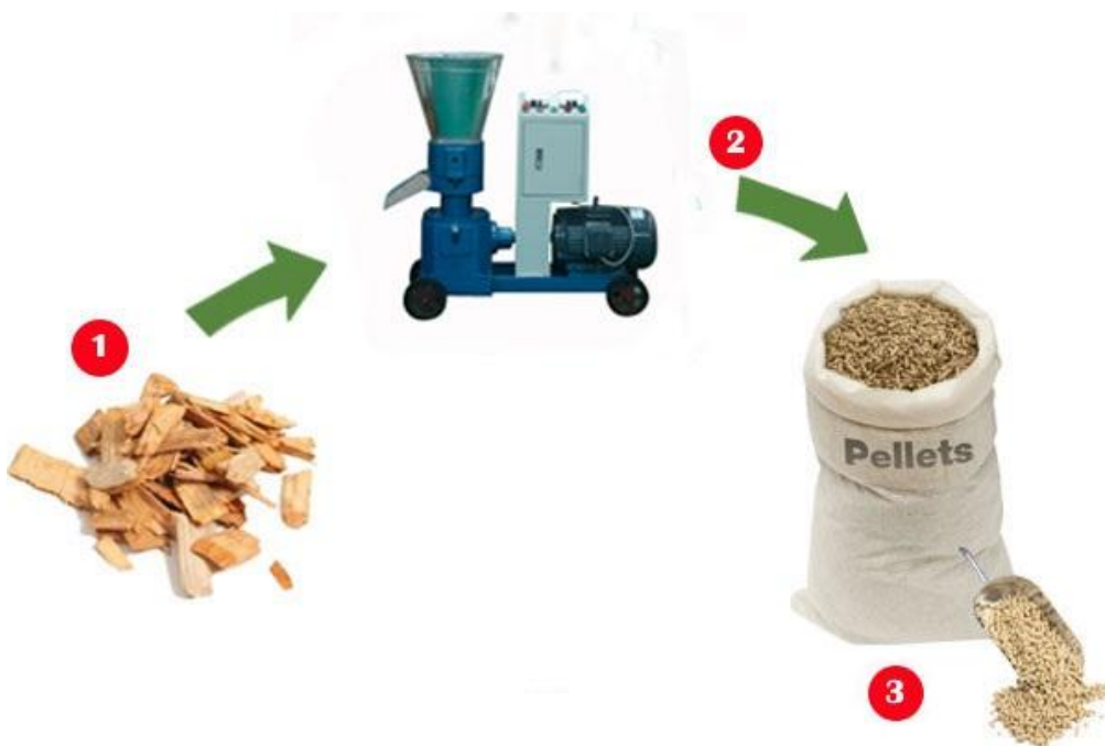
სურათი 4.3.1.8.2. ხე-ტყის მასალის დამუშავებიდან წარმოქმნილი ნარჩენების (ნახერხის, ბურბუშელას, ნათალის ) დამუშავების ტექნოლოგიური სქემა
