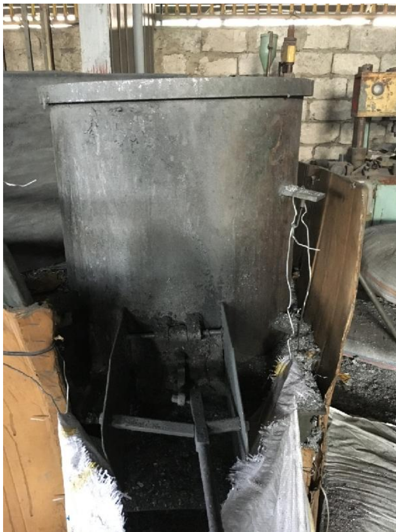
სურათი 2.3.1.7.1. ალუმინის ქილის დასაფქვავი დანადგარი (თვითნაკეთი)
