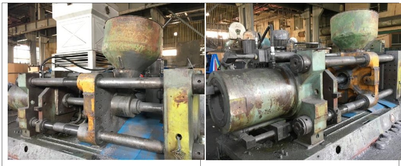
სურათი 2.3.1.7. 2. დაქუცმაცებული ალუმინის დასაწნეხი დანადგარი (თვითნაკეთობა)
