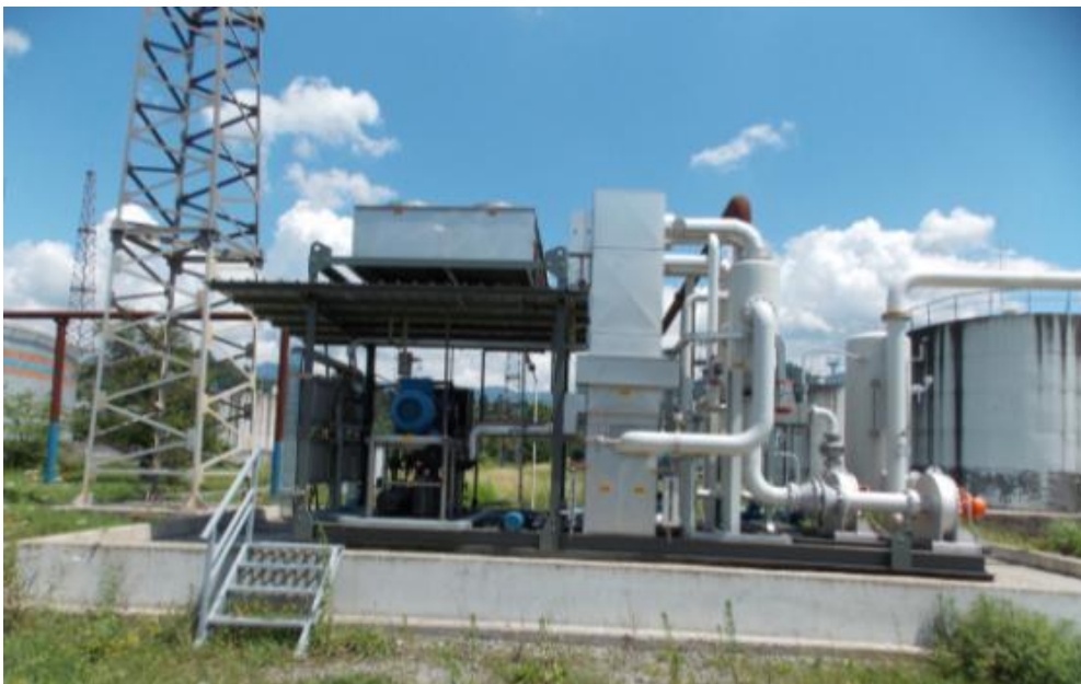
ნახაზი 3.4.5.1. ნავთობბაზის ნახშირწყალბადოვანი აირების სარეკუპერაციო დანადგარი
