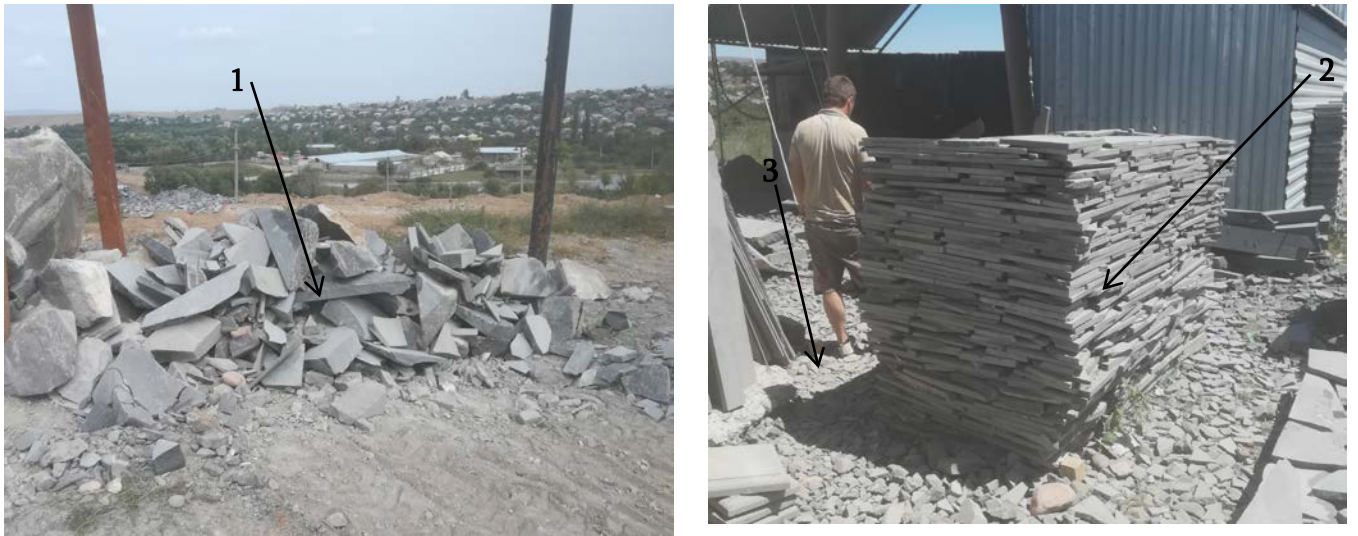
ნახ. 6. ტექნოლოგიური ნარჩენები. 1 - ნატეხები; 2 - ჩამონაჭრელები.
