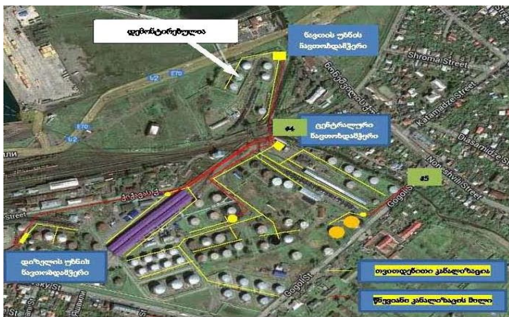
სურათი 3.11.4. ძირითად ტერიტორიაზე მუქი ნავთობპროდუქტების საწარმოო-სანიაღვრო კანალიზაციის გეგმა
