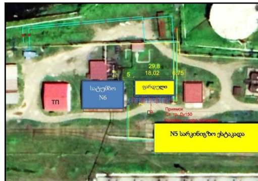
სურათი 4.10.1. სატუმბო სადგურის ფარდლის განთავსების სქემა
