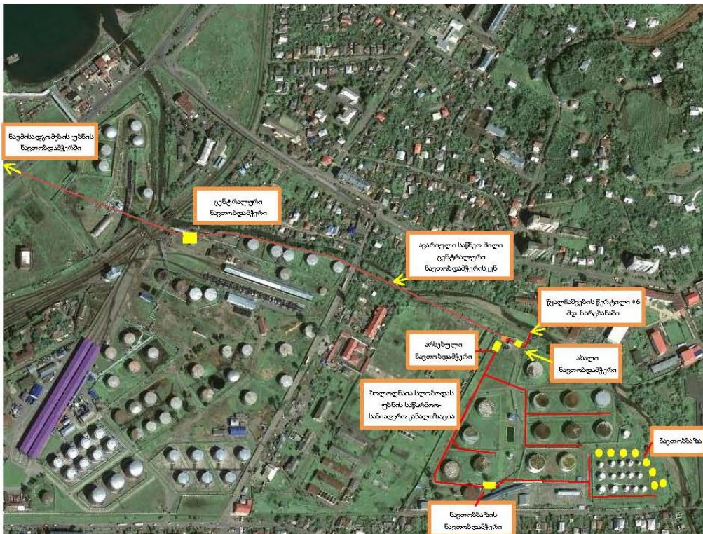
სურათი 3.11.15. N6 საწარმოო-სანიადგრო საკანალიზაციო სისტემის სიტუაციური გეგმა
