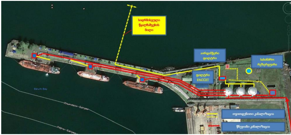
სურათი 3.11.5. ნავმისადგომების უბნის საწარმოო-სანიაღვრო კანალიზაციის სისტემის გეგმა
