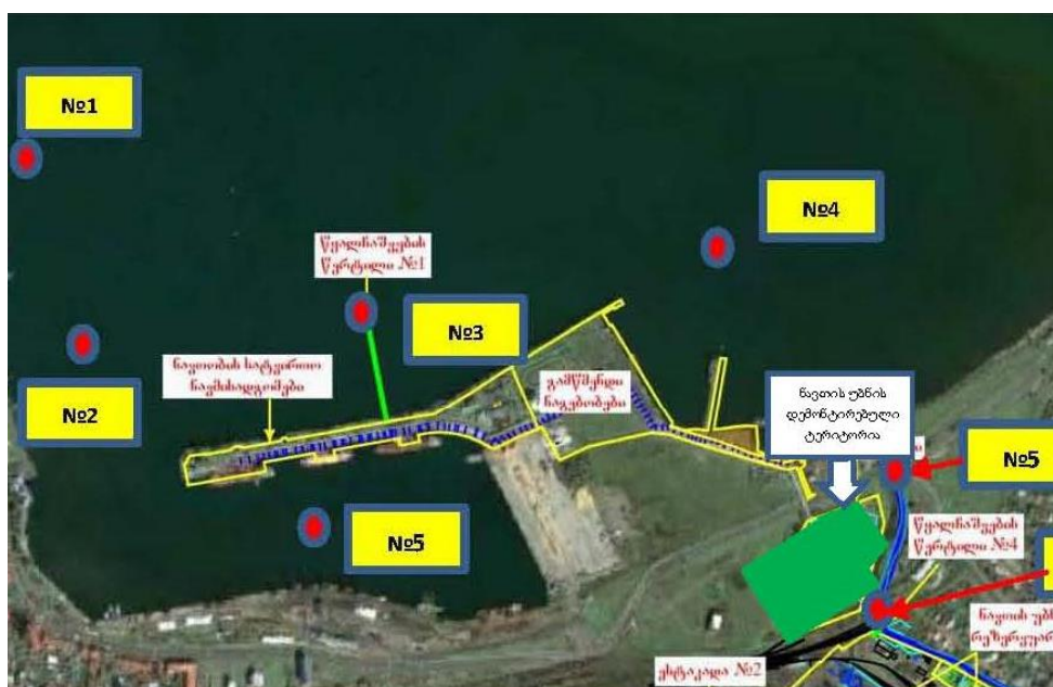
სურათი 9.1.1. პორტის აკვატორიაში ზღვის წყლის მონიტორინგის წერტილები და ბათუმის ნავთობტერმინალის საწარმოო ობიექტებიდან წყალჩაშების წერტილი №1
