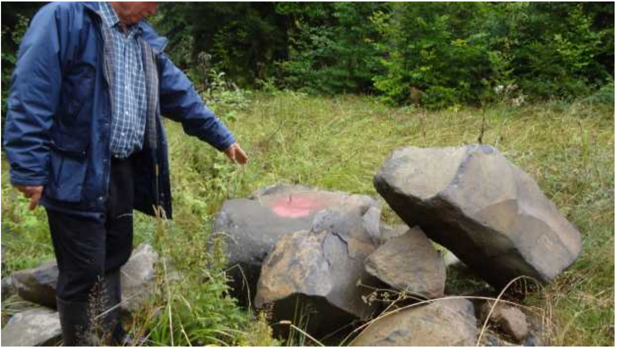
სურათი №10. 1 მ სიღრმიდან მაგთის და სილქნეტის ბოჭკოვანი კაბელების გაყვანისას ამოღებული ეფუზიური ქანების ფრაგმენტები – ანდეზიტები, ტუფოქვიშაქვები და ტუფობრეჭიები.
