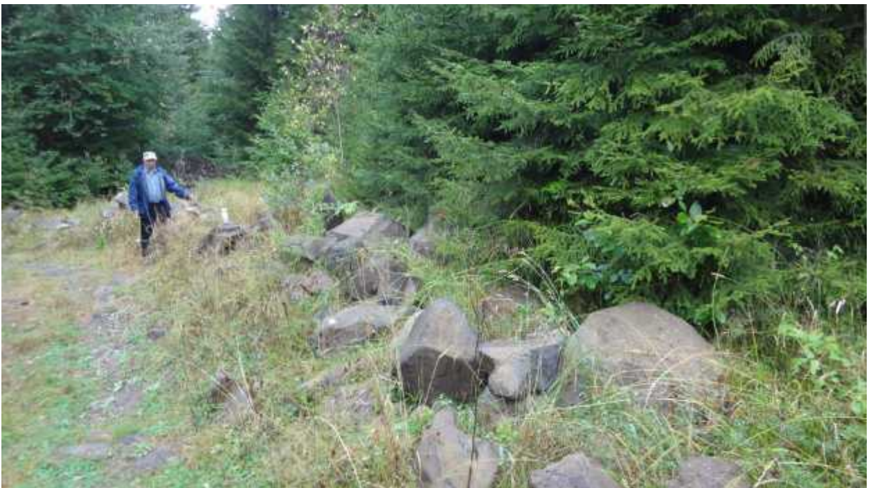
სურათი №9. გადაღებულია 100 მ-ში ქვემოთკენ - სამხრეთით რკინიგზის ხიდიდან. ამ მონაკვეთზეც ნათლად მოჩანს 1 მ სიღრმიდან ამოღებული ლოდების ფრაგმენტები, რომლებიც წარმოადგენენ გამოფიტვის ქერქის ნატეხოვან ზონას და ლითოლოგიურად წარმოდგენილებია ეფუზიური (ეულკანოგენურ დანალექი) ქანების ანდეზიტო - ბაზალტების სახესხვაობებით, რომლებიც გამოირჩევიან ფიზიკურ-მექანიკური თვისებების ძალიან მაღალი მაჩვენებლებით, სწორედ ამ ქანებზე გაივლის საპროექტი სადერევაციო მილსადენი.
