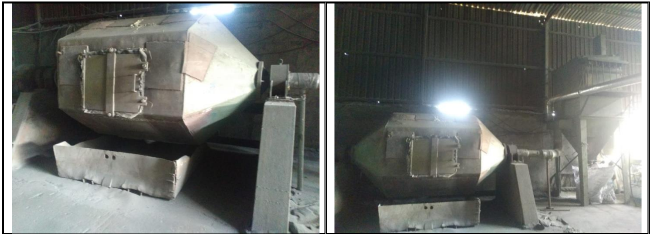
სურათი 4.1.11. MS2000 მოდელის წიდის გადამამუშავებელი დანადგარი
