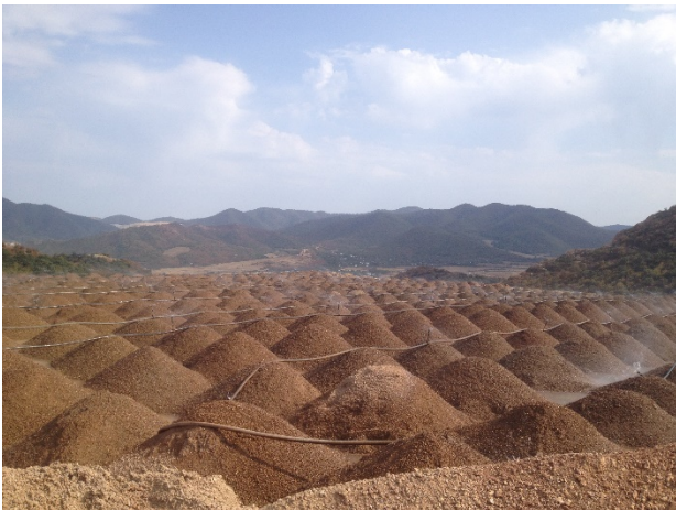
სურათი 1. გამოტუტვა-მეორად კვარციტებზე ნატრიციანიდული ხსნარის დასხურება
