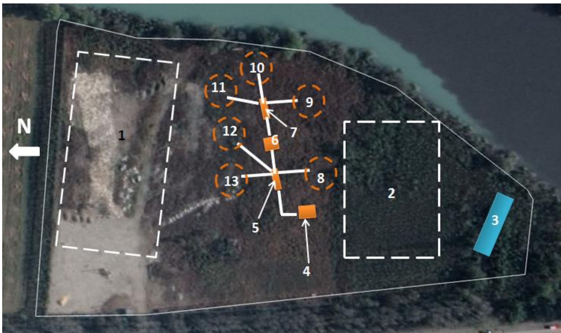
ნახაზი 6. 1. ნედლეულის განსათავსებელი ადგილი; 2. პროდუქციისა და ნედლეულის განსათავსებელი ადგილი; 3. სანიაღვრე წყლების სალექარი; 4. ყბებიანი მსხვრევანა; 5. ვიბროცხავი; 6. როტორული მსხვრევანა; 7. ვიბროცხავი; 8-13. ლენტური ტრანსპორტიორები და პროდუქციის განთავსების ადგილი.
