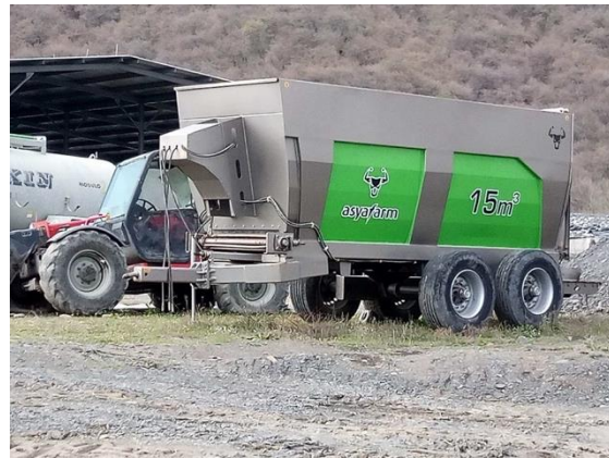
სურათი 3.7.2: ნაკელის სატრანსპორტო დანადგარი
