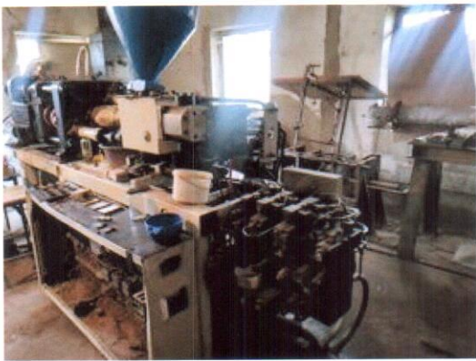
ექსპლიკაცია: 1. ძრავი; 2. რელექტორი; 3. ჩამტვირთავი მოწყობილობა; 4.კორპუსი; 5. ჭიახრახნი; 6. კორპუსის გამახურებელი; 7.გამაგრილებელი ვენტილატორი; 8. ექსტრუზიული თავაკი.
