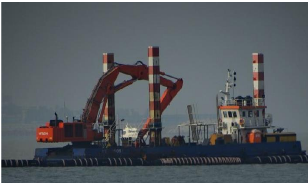
სურათი 3.34. მიწახაპია უკუნიჩაბით (დიტჩერი)
