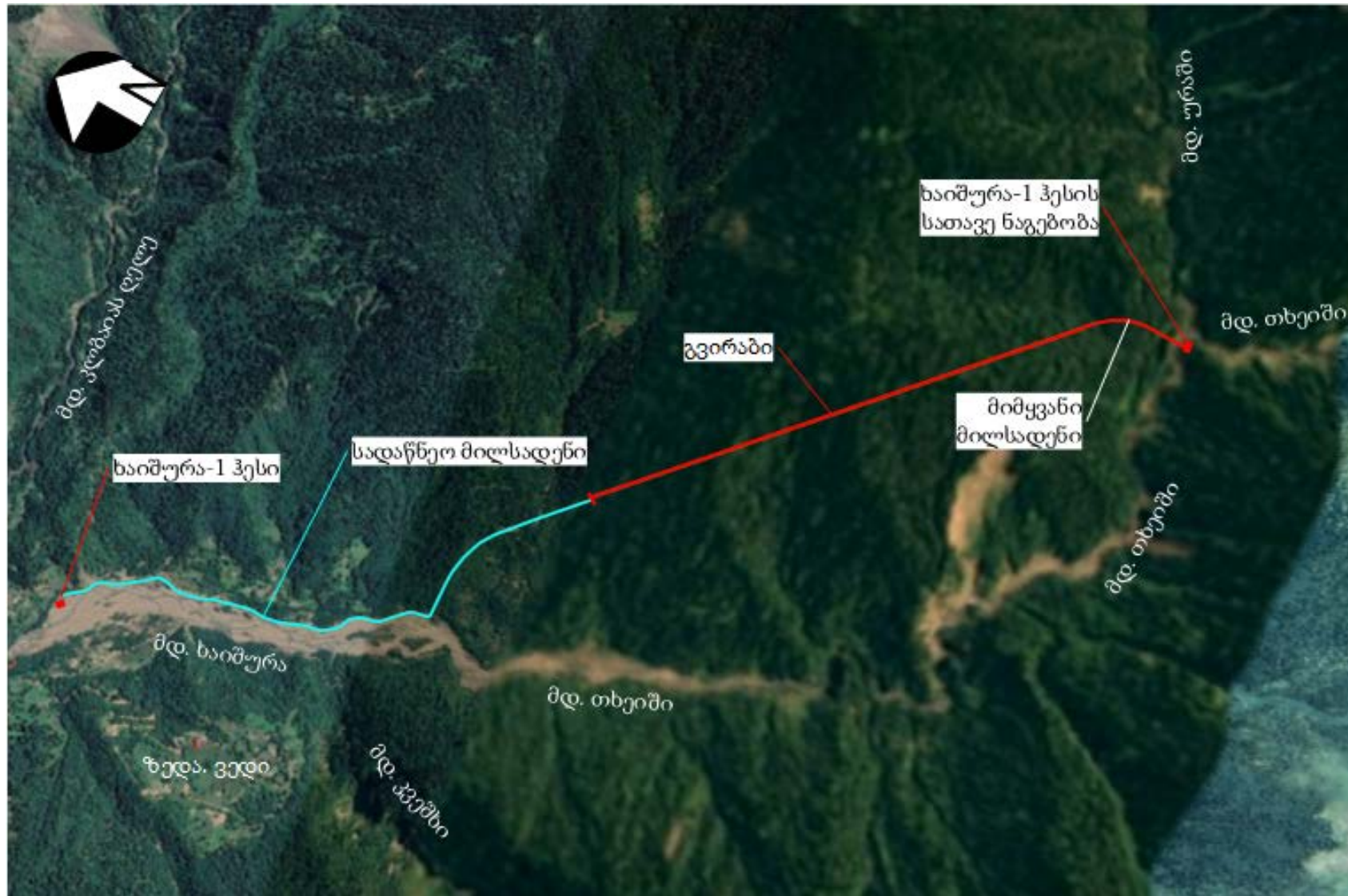
სურათი 2.2.1. ხაიშურა ჰესის კომუნიკაციების განლაგების სიტუაციური სქემა
