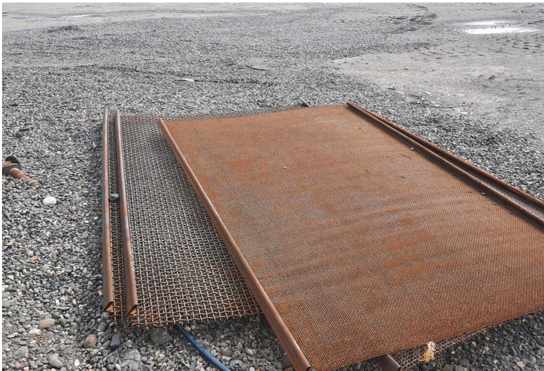
სურათი N18. ვიბროცხავეებზე დასაყენებელი ცხაურები.
