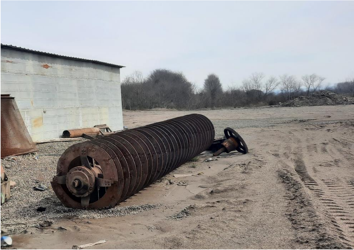
სურათი N19. კლასიფიკატორზე დასამონტაჟებელი სპირალი
