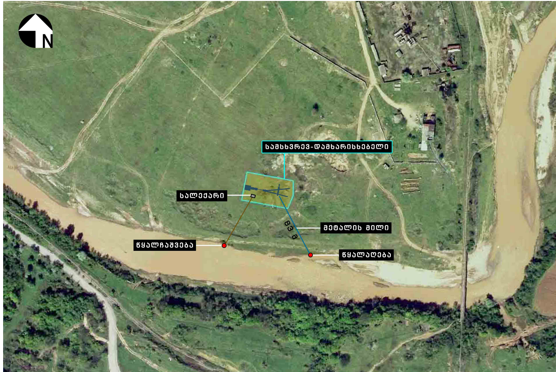
სურათი 2.2 ტექნოლოგიური დანადგარების განლაგების სქემა
