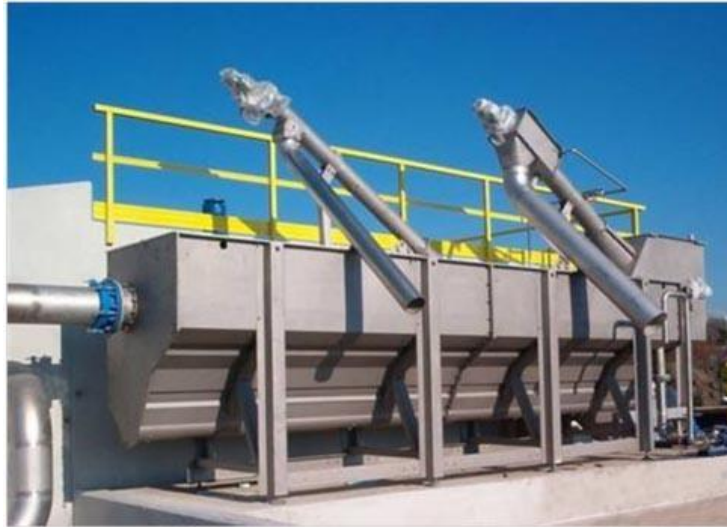
სურ. 7 - ტიპური კომბინირებული ცხაურის/ქვიშა/ცხიმის მოცილება
