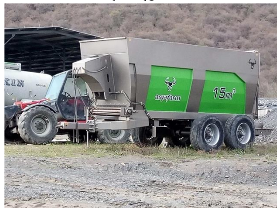
სურათი 3.7.2: ნაკელის სატრანსპორტო დანადგარი
