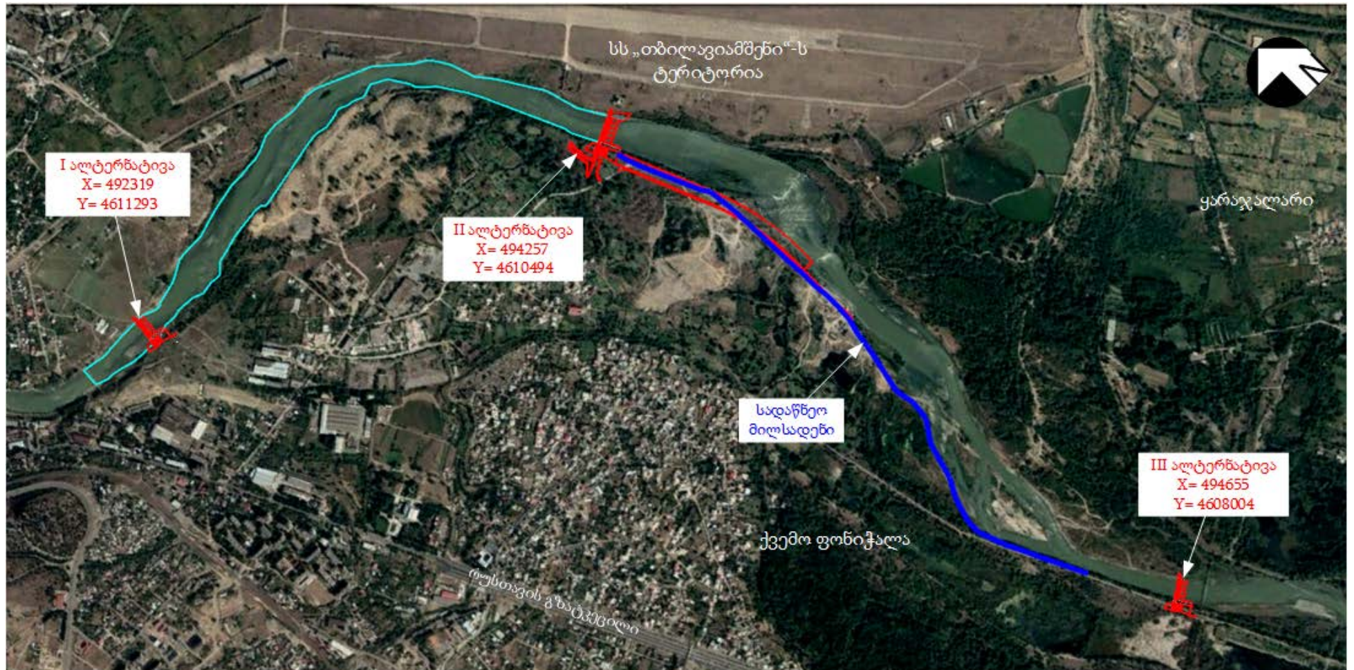
სურათი 2.2.1. კაშხლის განთავსების ალტერნატიული ვარიანტების სქემა
