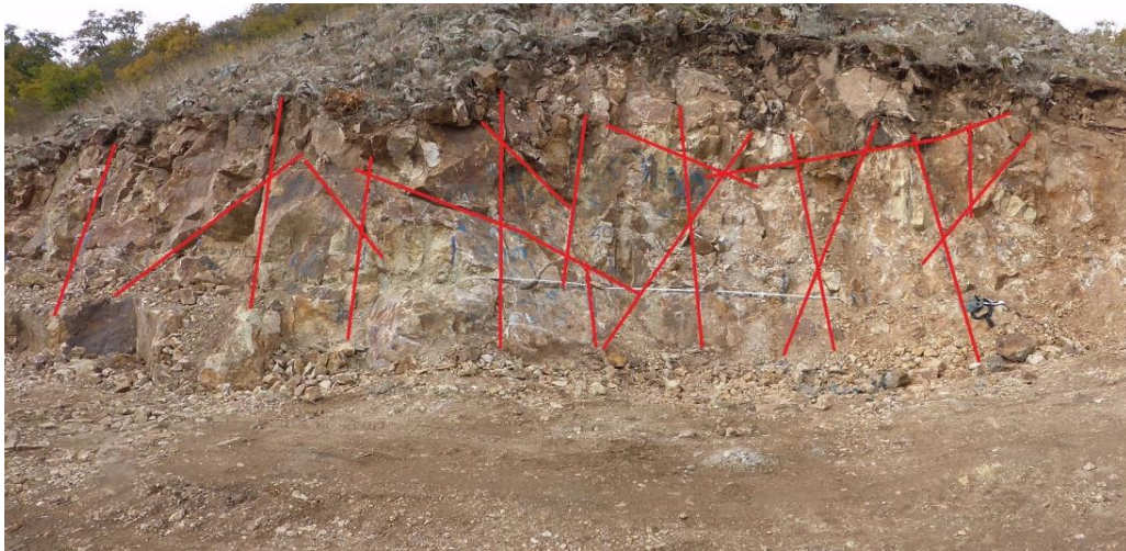
სურათი. 3.3.2 ქანების ნაპრალოვნება გაკვარცებული ტუფების ხელოვნურ გაშიშვლებაზე. მუშევანი 2 საბადოს ჩრდილოეთი ფლანგი
