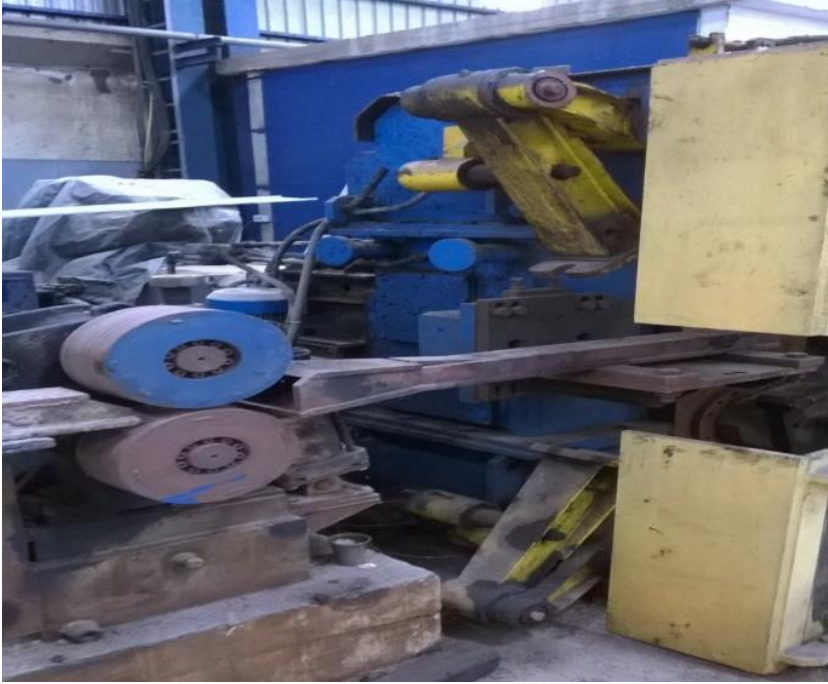
სურათი-7.4. მფრინავი მაკრატელი ტრაიპაპარატით
