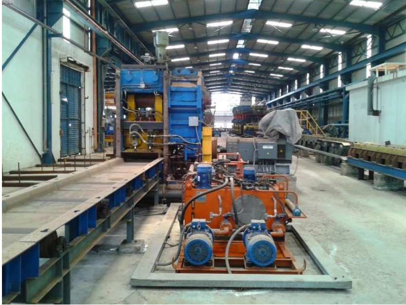
სურათი- 7.6. პროდუქციის საჭირო სიგრძეებზე დამჭრელი პრესმაკრატელი
