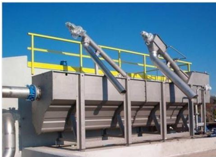
სურ. 7 - ტიპური კომბინირებული ცხაურის/ქვიშა/ცხიმის მოცილება
