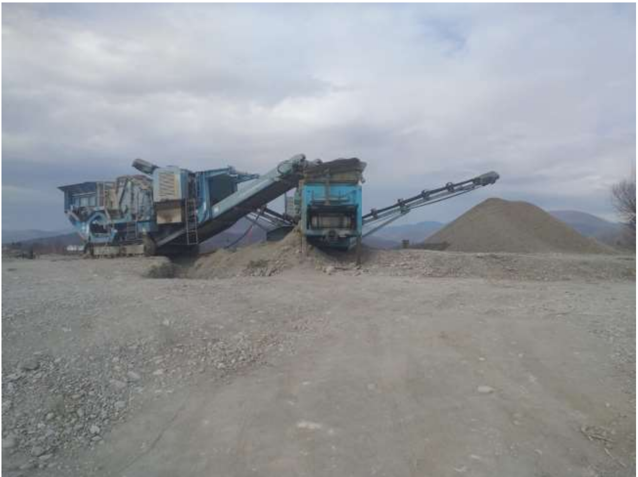
სურათი 2.1. მობილური ინერტული მასალების სამსხვრევ-დამახარისხებელი დანადგარი.
