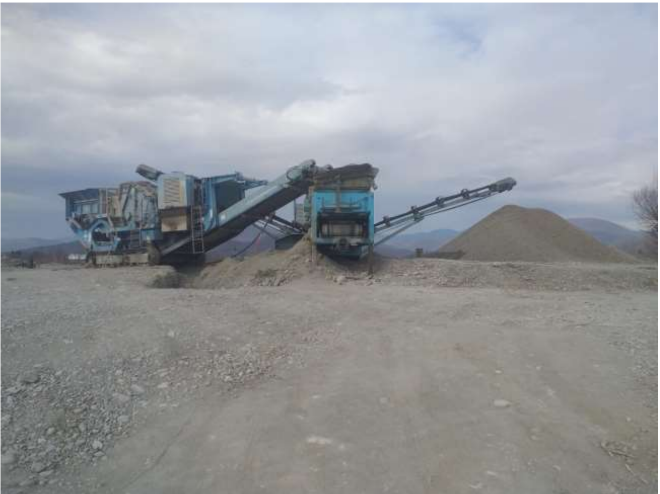
სურათი 2.1. მობილური ინერტული მასალების სამსხვრევ-დამახარისხებელი დანადგარი.
