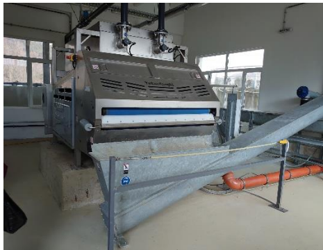
სურ. 15 - ლენტური წნეხის პრინციპული სქემა წინასწარი გაუწყლოვანების მოწყობილობით.
