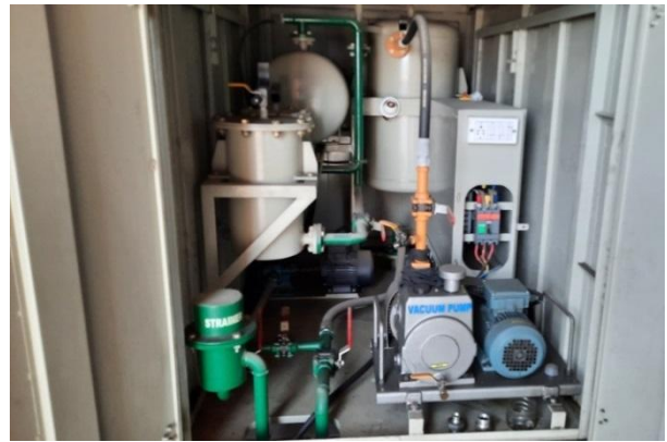
სურათები 3.4.1. საწარმოს ტერიტორიაზე არსებული სატრანსფორმატორო ზეთების რეგენერაციის და აღდგენის დანადგარის ხედები
