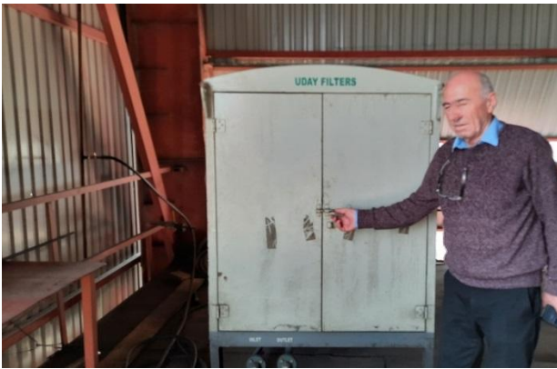
სურათები 3.4.1. საწარმოს ტერიტორიაზე არსებული სატრანსფორმატორო ზეთების რეგენერაციის და აღდგენის დანადგარის ხედები
