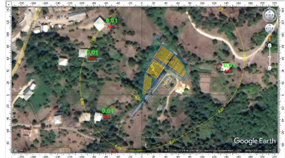
ნაგერი ნახშირწყალბადების (კოდი 2732) მაქსიმალური კონცენტრაციები საკონტროლო წერტილებში (№№ 1+ 4 უახლოეს დასახლებებთან და №№ 5+ 8 ნორმირებულ 500 მეტრიან ზონის საზღვარზე)
