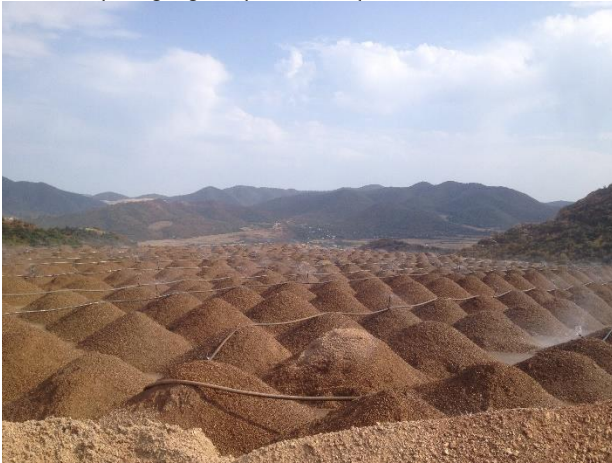
სურათი 1. გამოტუტვა-მეორად კვარციტებზე ნატრიციანიდური ხსნარის დასხურება
