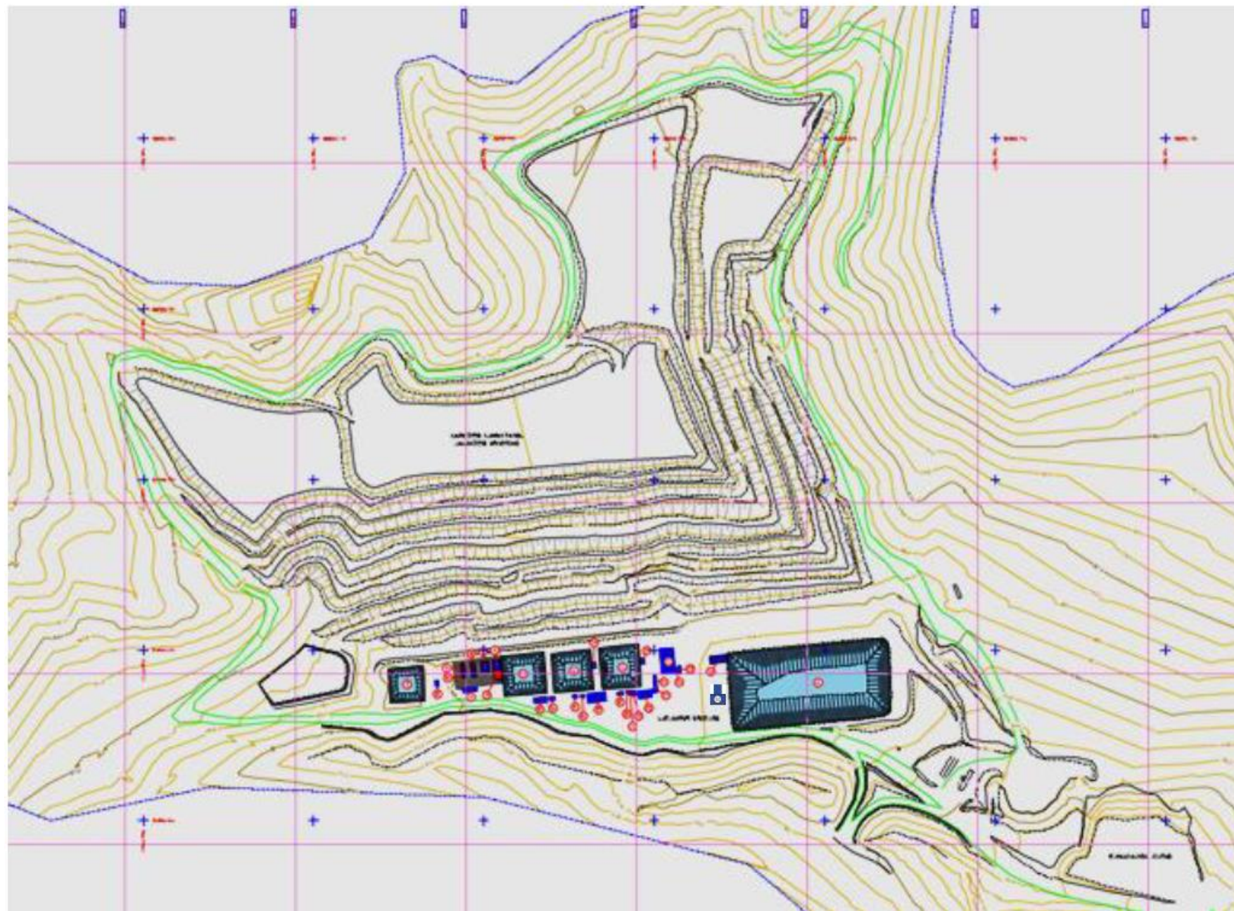
ნახაზი 2.2.1 არსებული გროვული გამოტუტვის საწარმოო უბნის გენერალური გეგმა
