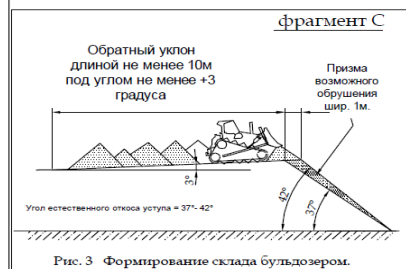
Рис. 3. Формирование склада бульдозером.
