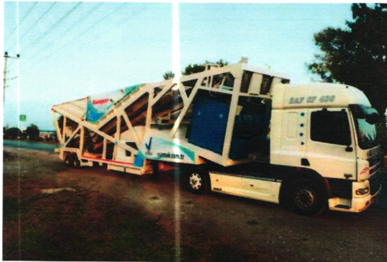
ნახ. 3.1.1 მობილური სამსხვრევი დანადგარი ტრანსპორტირების რეჟიმში
