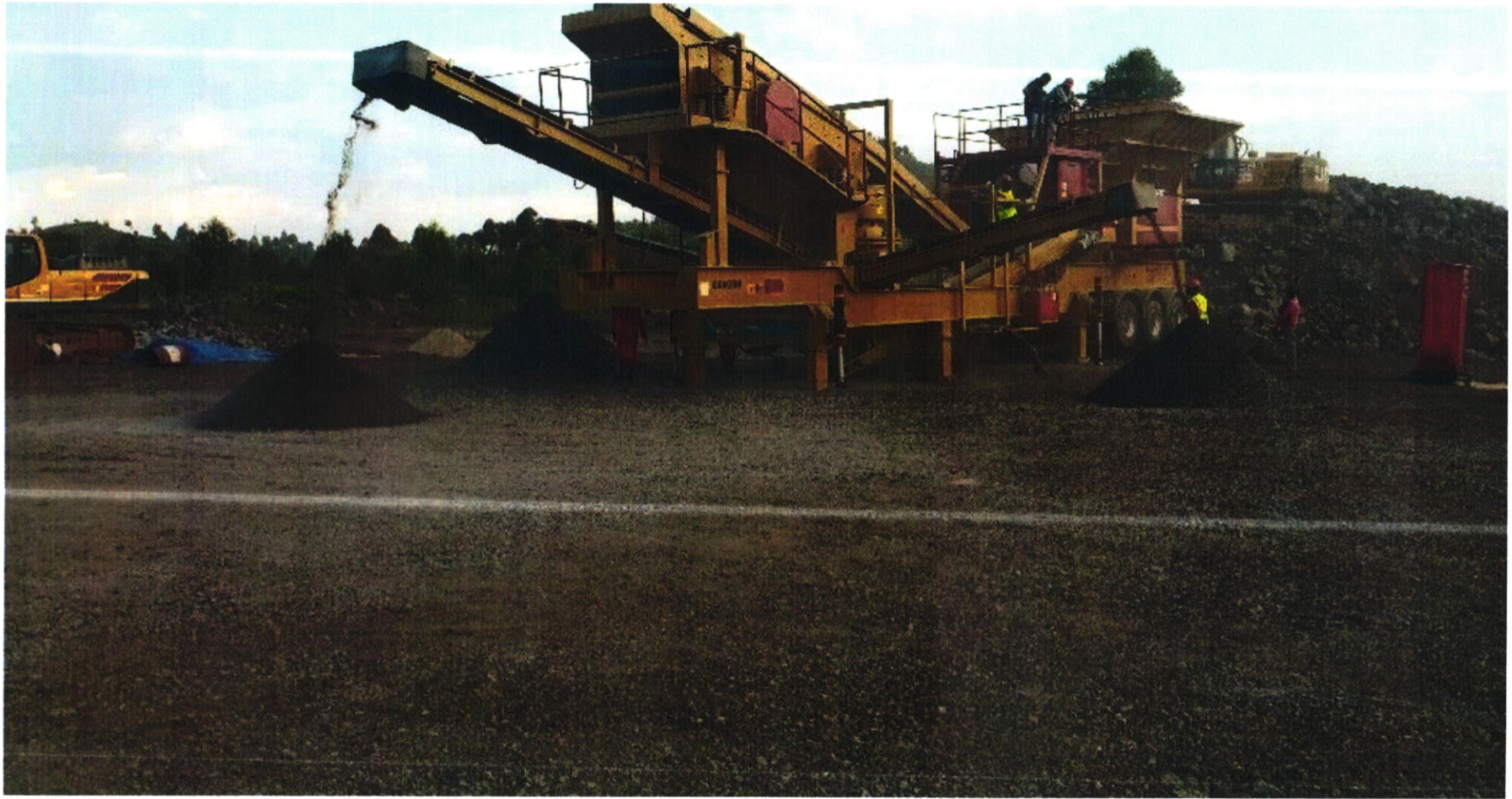
ნახ. 3.1.4 მობილურ სამსხვრევ-დამახარისხებელი საწარმოს ფოტო გაშლილ მდგომარეობაში
