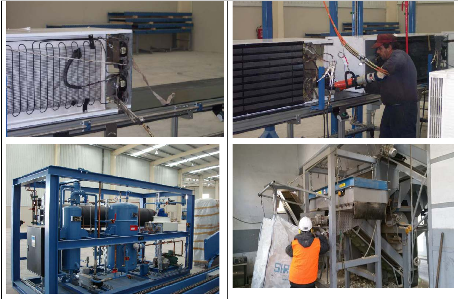
სურათი 4.2. მაცივრებისა და გამაგრილებელი ხელსაწყოების დამუშავების ტექნოლოგიურ პროცესები 1
