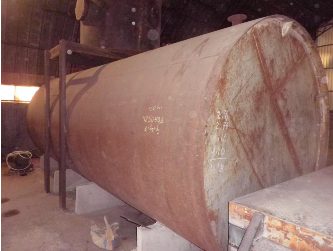
სურათი 4. დაქუცმაცემული ქალაქდნარევის მასის რეზერვუარი.
