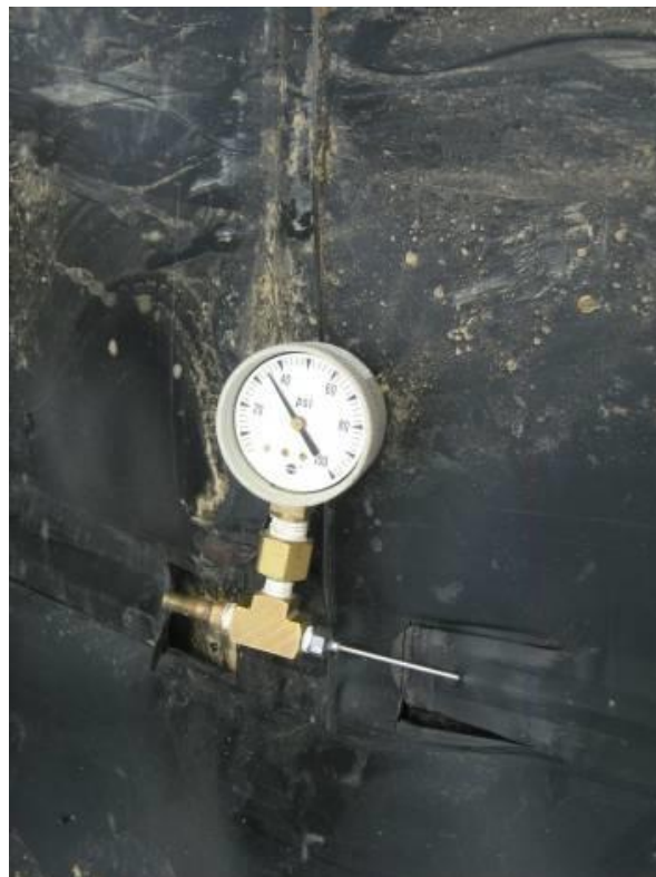
სურათი 2.3.2.4. შეკავშირების ნაკერების შემოწმება: ნაკერებს შორის ჩაიტუმბება ჰაერი, თუ მანომეტრში 10 წუთის განმავლობაში წნევა არ დაეცა, მაშინ ნაკერი ითვლება საიმედოდ
