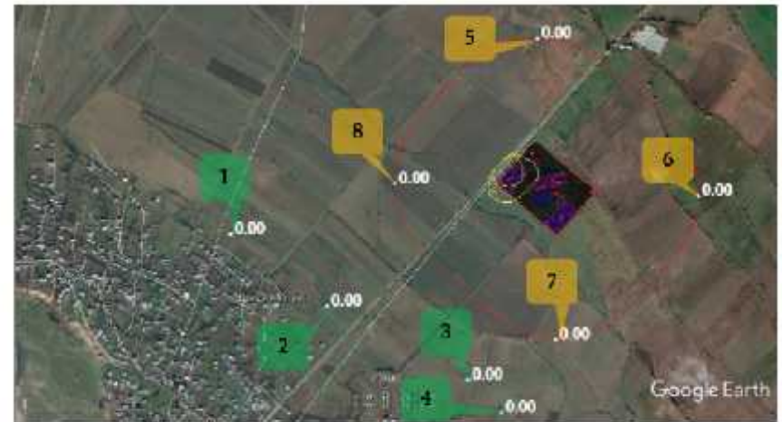
ვოჟიტის ოქსიდის (კოდი 301) მატონაღური კონცენტრაციები საკონტროლო წერტილებში (NIN: 1-4) ფახლოეს დასახლებებთან, და ნორმირებულ 500 მ-ის ზონის საზღვარზე (NIN: 5-8)
