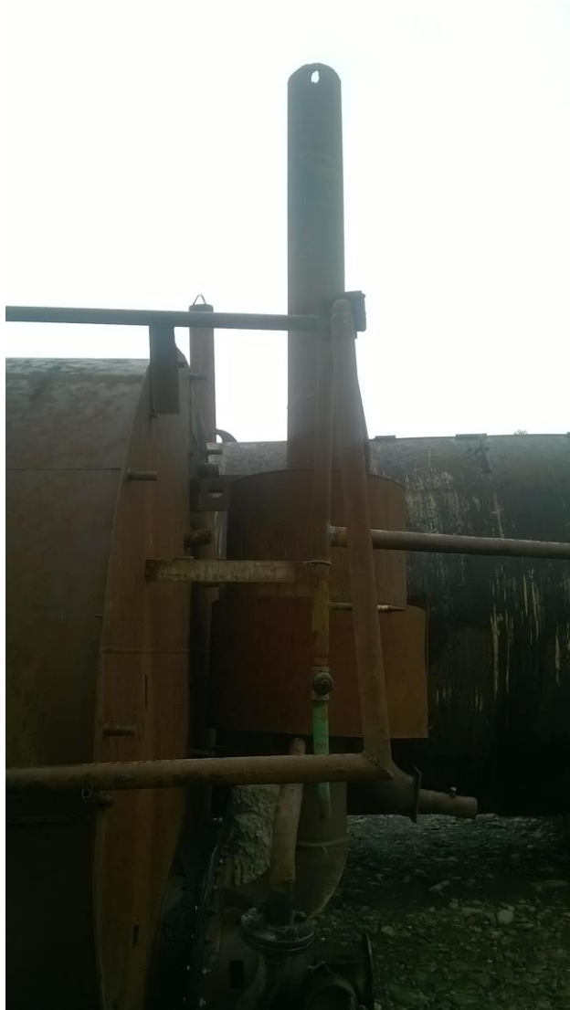
სურათი № 2.2.2. ბიტუმის გამაცხელებელი სანთურები გაფრეკვის მილით
