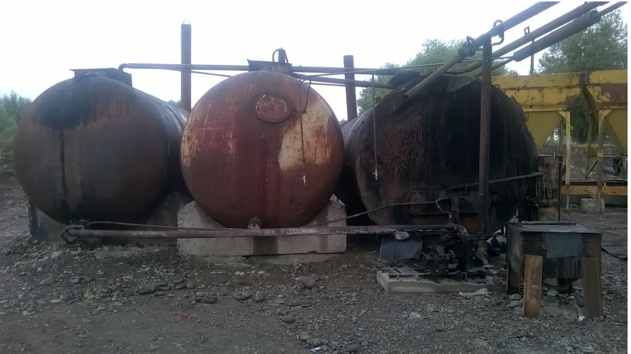
სურათი № 2.2.2. ბიტუმის გამაცხელებელი სანთურები გაფრეკვის მილით
