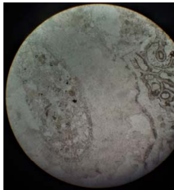
სურ. 1. კარბონატული შედგენილობის ბიოკლასტური მასალა ფსამიტ-ალევიტულ კრისტალოკლასტებთან ერთად, შეცემენტებული პელიტური კარბონატული ცემენტით. გადიდება 40x.
