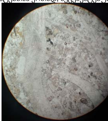
სურ. 2. კარბონატული შედგენილობის ბიოკლასტური მასალა ფსამიტ-ალევიტულ კრისტალოკლასტებთან ერთად, შეცემენტებული პელიტური კარბონატული ცემენტით. გადიდება 40x.
