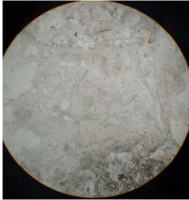
სურ. 4. კარბონატული შედგენილობის ბიოკლასტური მასალა ფსამიტ-ალევიტულ კრისტალოკლასტებთან ერთად, შეცემენტებული პელიტური კარბონატული ცემენტით. გადიდება 40x.
