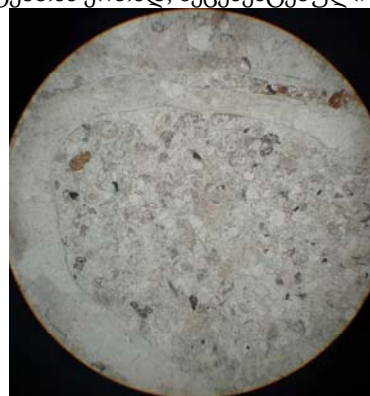
სურ. 3. კარბონატული შედგენილობის ბიოკლასტური მასალა ფსამიტ-ალევიტულ კრისტალოკლასტებთან ერთად, შეცემენტებული პელიტური კარბონატული ცემენტით. გადიდება 40x.
